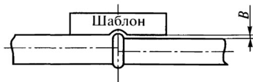
Рис. 10. Схема определения смещения кромок стыкуемых труб
