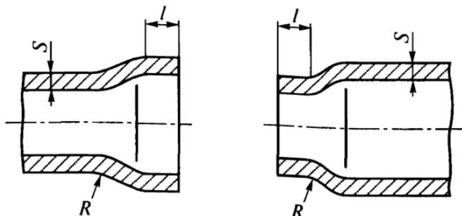
Рис. 5. Отбортованный и переходный элемент
