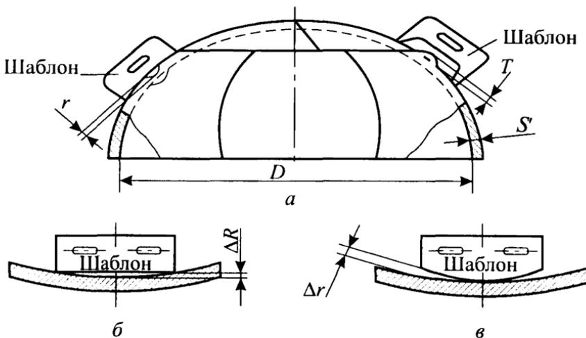
Рис. 7. Отклонение формы полусферического дна
