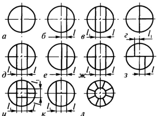
**Рис. 1.** Расположение сварных швов заготовок выпуклых днищ
