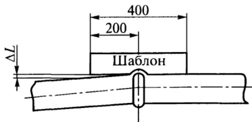
Рис. 11. Схема определения отклонения от прямолинейности оси трубы
