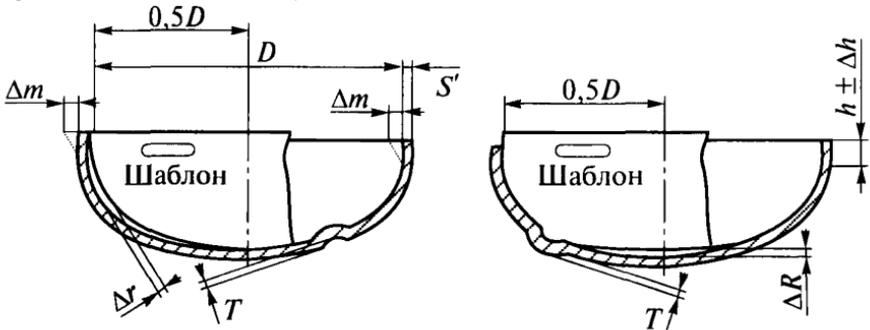
**Рис. 6.** Отклонение размеров и формы эллиптического днища
